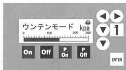
運転時のPLC画面表示
